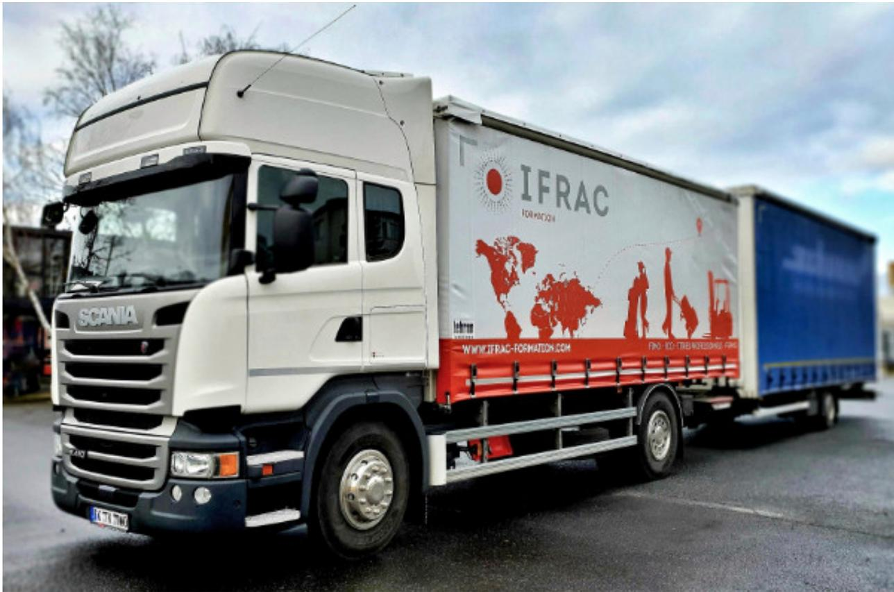
Das Gespann ist tiefgekuppelt mit automatischer Anhängerkupplung.
