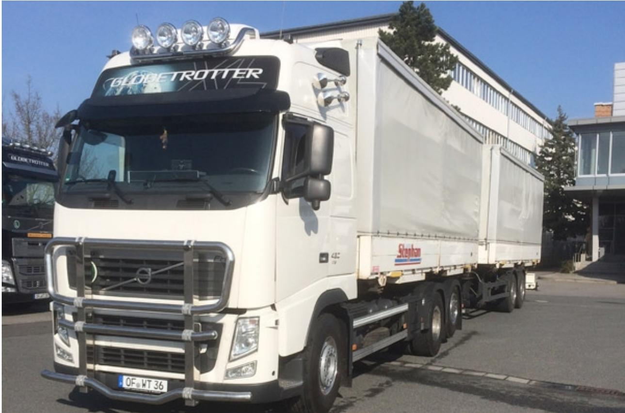
Unser FH3 460 EEV, ausgerüstet mit Notbremsassistent, Abstandsregelautomat ACC, Kamerasystem und Standklima, zeichnet sich auch durch seine vier luftgefederten Sitze, seine Vollluftfederung und I-Shift-Automatik aus.
